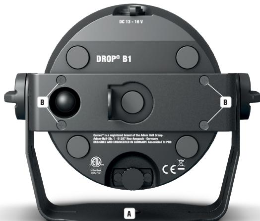
Aby móc efektywnie korzystać z funkcji pochylenia ustawianej za pomocą śruby, w przypadku zastosowania urządzenia jako reflektora, i uzyskać bardziej dyskretny wygląd, należy zdemontować uchwyt montażowy przez połuzowanie za pomocą odpowiedniego narzędzia czterech śrub T10 Torx (B), które mocują wspornik montażowy do obudowy reflektora.
