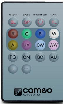
Activer le pilotage par la télécommande infrarouge dans les paramètres système de réglage sous « IR Remote » (IR Remote On). Diriger ensuite la télécommande infrarouge par contact visuel directement vers le capteur infrarouge situé sur la face avant du projecteur. Sa portée maximale est d'environ 8 mètres. Désactivez le pilotage par télécommande infrarouge (IR Remote Off) dès que vous souhaitez piloter le projecteur via W-DMX.
