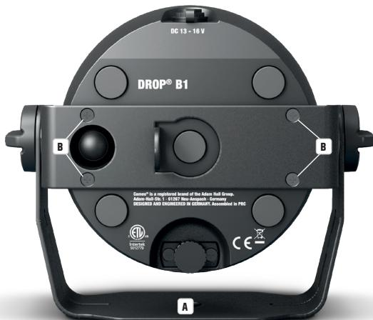
Um die Tilt-Funktion mittels Tilt-Schraube bei der Verwendung als Uplight wirksam nutzen zu können und um eine dezentere Optik zu erzielen, muss der Montagebügel demontiert werden, indem Sie die vier Torxschrauben T10 (B), die den Montagebügel am Scheinwerfergehäuse halten, mit einem geeigneten Werkzeug lösen.
