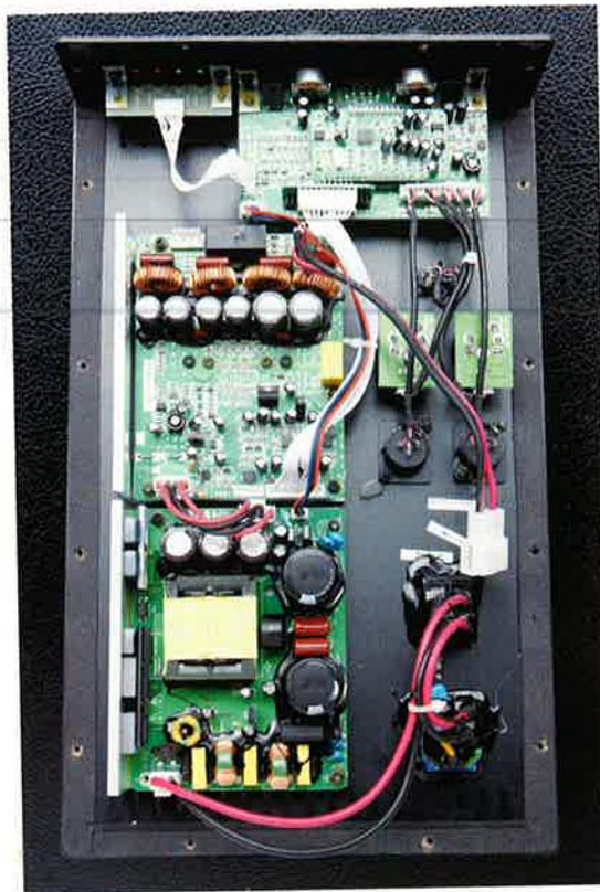
Blick unter die Haube auf die Platine mit Endstufe und DSP
