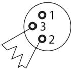
La terminación reduce los problemas de transmisión de la señal y las interferencias. Se recomienda conectar un terminador DMX, (resistencia de 120 ohmios y 1/4 W) entre el pin 2 (DMX-) y el pin 3 (DMX+) del último equipo.
