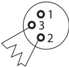
Die Verwendung eines Abschlusswiderstands (Terminierung) reduziert Interferenzen und andere Probleme bei der Signalübertragung. Es ist immer ratsam, ein DMX-Abschlussmodul (Widerstand 120 Ohm, 1/4 W) zwischen Pol 2 (DMX-) und Pol 3 (DMX+) des letzten Geräts in der Kette einzufügen.
