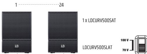
2 satelliti CURV 500 per ciascun adattatore SmartLink da 70V = numero massimo 12 adattatori SmartLink (12 x 40W = 480W max.)
