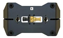
Zum Ausklappen des TV-Zapfens ziehen Sie den gefederten Verriegelungsbolzen in Pfeilrichtung aus dem Verriegelungsloch (Abbildung D), klappen den TV-Zapfen nach vorne und lassen den Verriegelungsbolzen in das um 90° versetzte Verriegelungsloch einrasten (Abbildung D).
