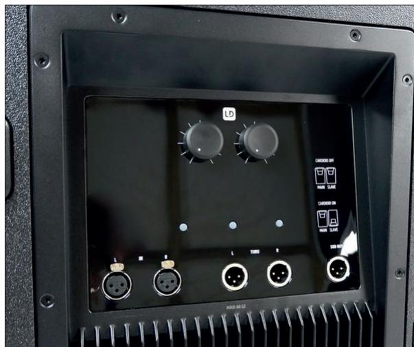
Die Maui 44 G2 hat zwei Eingänge, zwei Thru-Ausgänge und einen Sub-Out für einen Basslautsprecher im Cardioid-Modus (Nierenaufbau)
