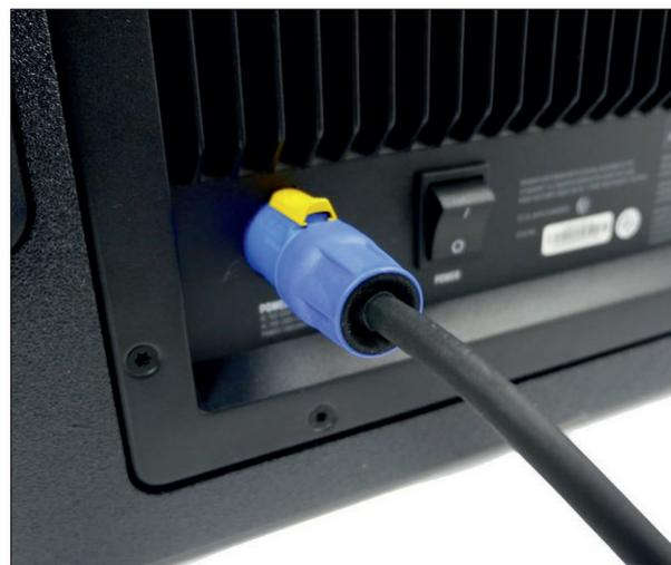
Die Stromzufuhr erfolgt durch eine verriegelbare Speakon-Buchse
