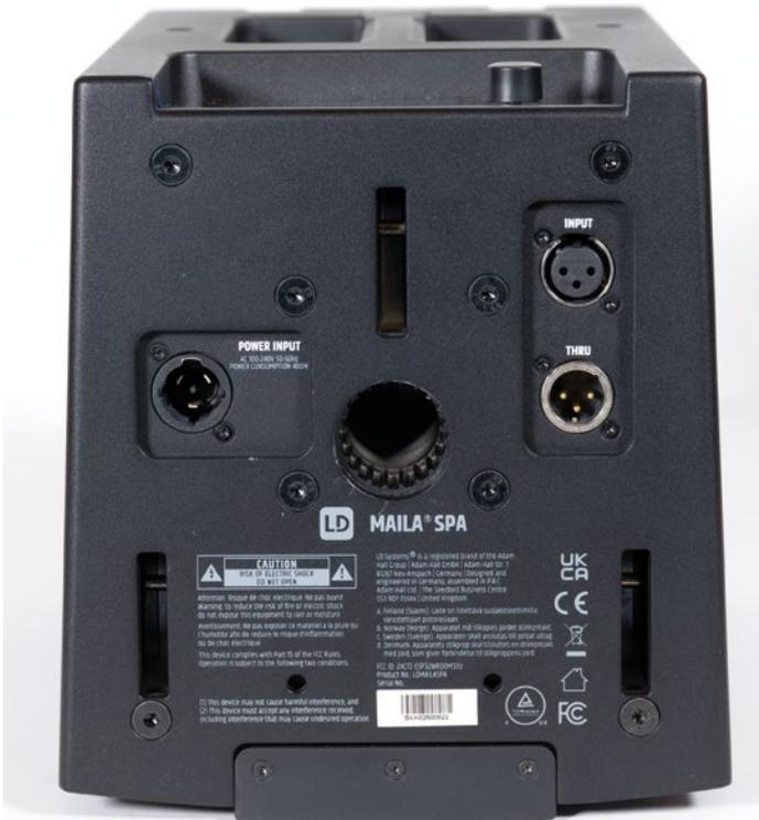
**Anschlüsse für Stromversorgung und Signalzuspielung** an der Verstärkereinheit SPA. Im Boden/Deckel sind eine Stativhülse für die Aufstellung auf einem Stativ oder Subwoofer und die drei länglichen Öffnungen zur Aufnahme des EasyMount Flugadapters vorhanden
