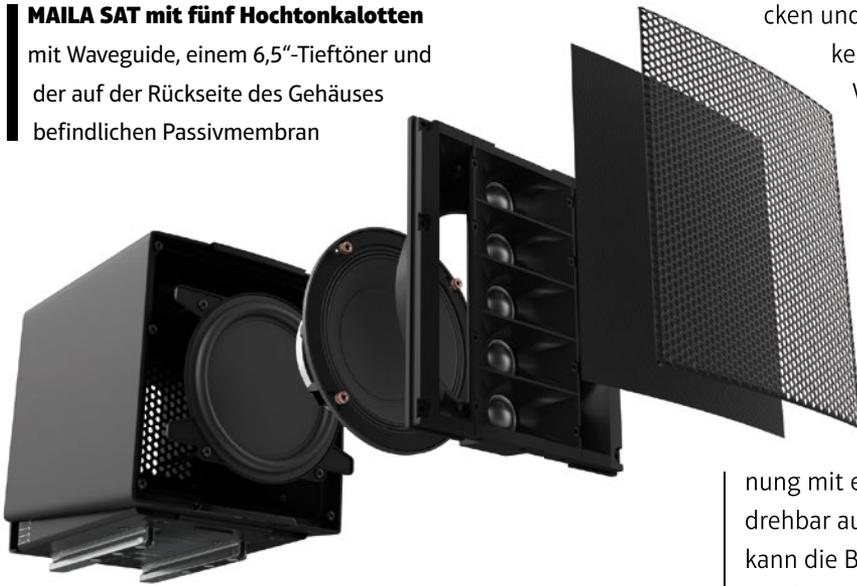
Die Verbindung der SAT-Gehäuse erfolgt mechanisch und elektrisch über Schienen und Nuten an der Unter- und Oberseite der Gehäuse. Sobald die SmartLink+ Verbindung eingerastet ist erscheinen die gekoppelten MAILAs nach außen als eine Einheit ohne erkennbare Mechanik. Über sechs in die Schienen integrierte Kontakte werden die Audiosignale für die beiden Wege und die Stromversorgung sicher übertragen. Die MAILA SAT benötigen somit weder eine nach außen sichtbare Verkabelung noch eine Flugmechanik.
