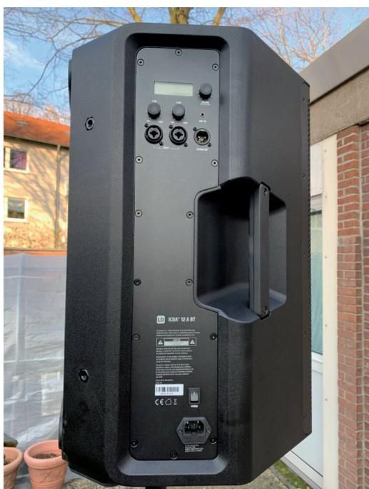
*Die Rückseite der LD Systems ICOA Serie wirkt sehr aufgeräumt. Das leicht nach innen versetzte Anschlussfeld sorgt dafür, dass Kabel im Monitorbetrieb nicht scharf abgeknickt werden*
