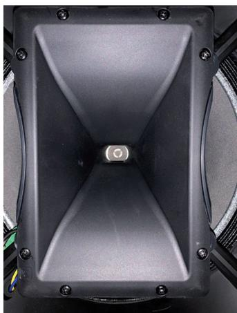
*Hochtontreiber und Horn sind in koaxialer Anordnung vor den Tieftontreiber gebaut. Das Horn lässt sich für den Monitorbetrieb oder die horizontale Installation drehen.*
