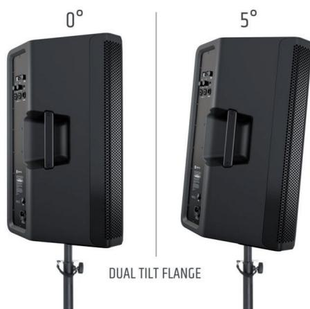
Jeder Lautsprecher verfügt zudem über zwei Flansche für 0° und 5°-Anwinkelung auf einem Stativ. So wird das Publikum beschallt und nicht die Rückwand. Auf den Boden gelegt ergibt sich ein Monitorwinkel von 55°. Des Weiteren notiere ich sechs M10 Flugpunkte und vier gummibeschichtete Aluminiumgriffe (oben/unten/rechts/links). Letztere sollen den Tragekomfort erhöhen.
