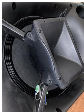
*Das Hochtornhorn wird von vier Kunststoffstreben in Position gehalten. Nach Lösen der vier Schrauben und der Verkabelung kann es gedreht werden.*
