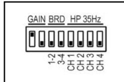
**Subsonicfilter eingeschaltet:** Die Endstufe arbeitet mit Subsonic-Hochpassfilter (35Hz), Pegelwerte 32dB und ohne Bridgemodus.
