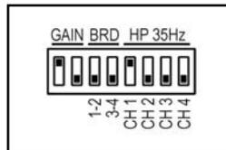
**Bridgemodus:** Die Endstufe arbeitet ohne Subsonic-Hochpassfilter, Pegelwerte 32dB und Bridgemodus.
