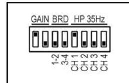
**Ponté activé:** le filtre passe-hauts/subsonique est deactivée, sensibilité 32dB et la configuration ponté activé.
