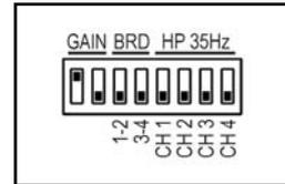
**Filtre subsonique activé:** le filtre passe-hauts/subsonique est activé, sensibilité 32dB et la configuration ponté deactivée.
