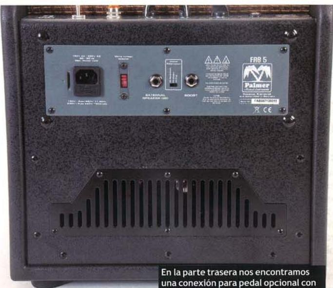
En la parte trasera nos encontramos una conexión para pedal opcional con el que controlar el boost, y otra para añadir un altavoz externo.
