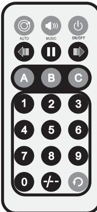
**Richten Sie die Infrarot-Fernbedienung in Sichtverbindung entweder direkt auf den auf der Vorderseite oder der Rückseite der Lichtanlage verbauten Infrarot-Sensor. Die maximale Reichweite beträgt ca. 8 Meter. In der DMX- und der Slave-Betriebsart sind die Funktionen der Fernbedienung deaktiviert (Batterie für IR Fernbedienung: CR2025).**
