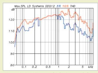
Abb. 10: Maximalpegel für max. 3 % (blau) und max. 10 % (rot) Verzerrungen. Für den Tieftöner greift oberhalb von 200 Hz der Limiter ein.
