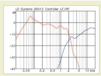
Abb. 4: Filterfunktionen des internen DSP-Controllers. Für den Tieftöner wird ein Hochpassfilter 2. Ordnung zum Schutz vor tiefen Frequenzen unterhalb der Abstimmfrequenz eingesetzt.
