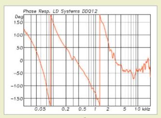
Abb. 6: Phasengang der DDQ12. Der Übergang geschieht in der Summe aus elektrischem und akustischem Filter mit 4. Ordnung. Am unteren Ende des Frequenzbandes dreht sich die Phase durch das Bassreflexgehäuse um 360° und um zusätzliche 180° durch das elektrische Hochpassfilter.
