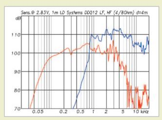
Abb. 2: Frequenzgang und Sensitivity der beiden Wege ohne Controller. Beide Wege wurden für 2,83 V gemessen. Die 1 W / 1 m Sensitivity des Tieftöners ist somit 3 dB niedriger als hier gezeigt.
