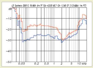
Abb. 11: Intermodulationsverzerrungen bei 99 dB LAeq in 4 m (blau) und beim Einsetzen des Limiters (rot), wo dann 102 dB LAeq in 4 m gemessen werden. Der dabei erreichte Spitzenpegel Lzpk bezogen auf 1 m Entfernung beträgt 129 dB.
