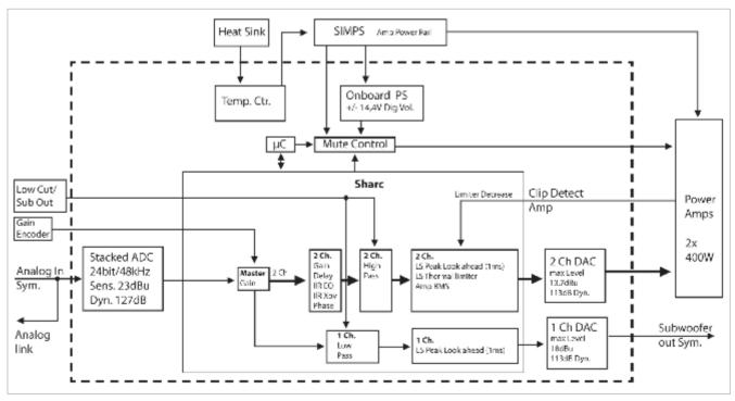
Abb. 3: Blockschaltbild der internen Elektronik
