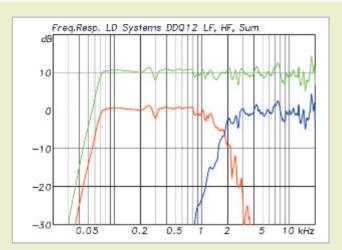
Abb. 5: Frequenzgang der DDQ12 (grün) insgesamt und der beiden Wege LF (rot) und HF (blau)
