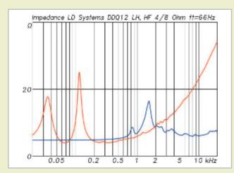
Abb. 1: Impedanzverläufe der beiden Wege. Der Tieftöner (rot) ist zur besseren Ausnutzung der Endstufe ein 4- $\Omega$ -System. Das Bassreflexgehäuse ist auf 66 Hz abgestimmt.
