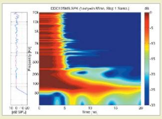
Abb. 7: Spektrogramm der DDQ12. In den Mitten sind einige kleine Resonanzen zu erkennen. Bei 300 Hz gibt es eine Gehäusemode.
