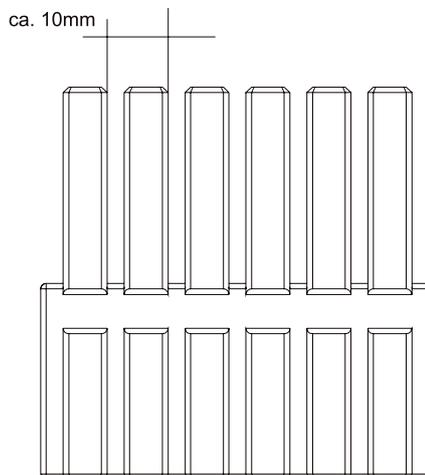
Die Trennleisten bestehen aus Kunststoff und sind speziell auf unsere 19" Schubladen abgestimmt. Entsprechend verfügen wir über 2 Varianten: P1 für Breite und P2 für die Tiefe unserer Schubladen.
