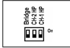
**Filtro subsónico activado:** el amplificador funciona con el filtro paso alto subsónico activado en el canal 1 (35 Hz en este caso) y el modo puente desactivado.
