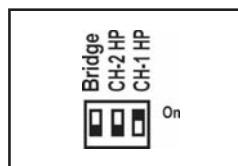
**Modo Puente:** el amplificador funciona sin filtro paso alto subsónico y el modo puente activado entre canal 1 y canal 2.
