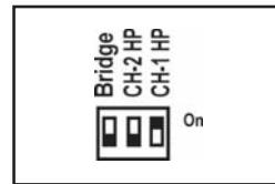
**Bridgemodus:** Die Endstufe arbeitet ohne Subsonic-Hochpassfilter, und Bridgemodus.
