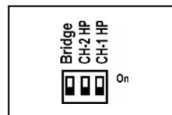
**Subsonicfilter eingeschaltet:** Die Endstufe arbeitet mit Subsonic-Hochpassfilter (35Hz), und ohne Bridgemodus.
